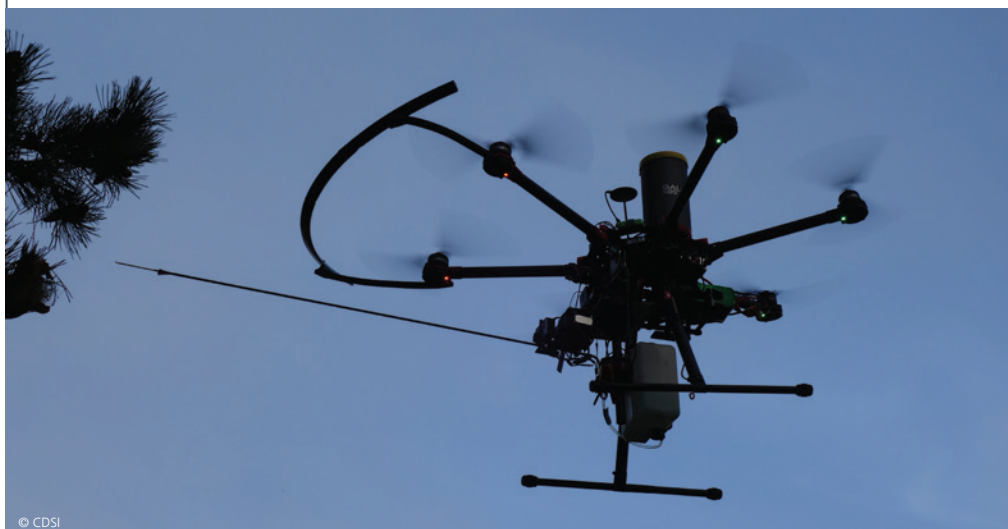
Le drone conçu par CDSI lors d'une opération de traitement d'un nid de chenilles processionnaires
