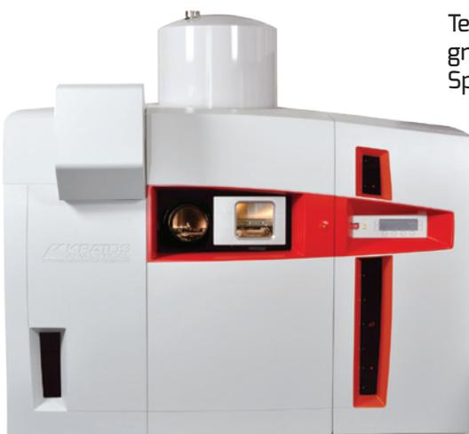
Tescan Analytics élargit son offre grâce à l'acquisition d'un nouveau Spectromètre XPS (Spectroscopie de Photoélectrons X) Axis Nova, équipé d'un Canon Cluster Argon. Cet équipement permet à la SRC d'adresser plus de thématiques, notamment sur les matériaux organiques.
