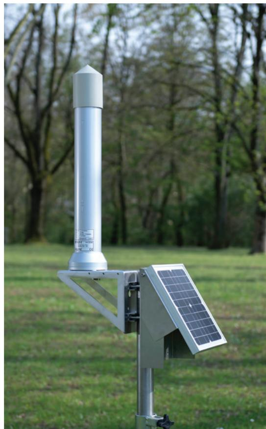
Sonde autonome GammaTRACER XL2 avec panneau solaire
