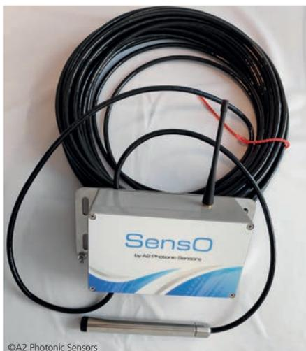
L'expérimentation SensO du nom de cette 1<sup>ère</sup> station limnimétrique IoT d'EDF DTG nourrit l'imagination de la station de demain d'EDF DTG : facilité, rapidité d'installation, autonomie, discrétion ou encore réception instantanée des données sur applications mobiles. La multiplication des données sur la ressource eau permet d'accroître la qualité des prestations d'EDF DTG.
