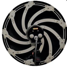
Après plusieurs années de recherche et de développement, la PME rhônalpine MicroDB annonce la fabrication de la 100e caméra acoustique. Fruit de sa collaboration avec la SRC Centum Adeneo, cette caméra acoustique permet de localiser et quantifier les sources de bruit dans des environnements complexes tout en offrant autonomie et rapidité de mise en œuvre.
